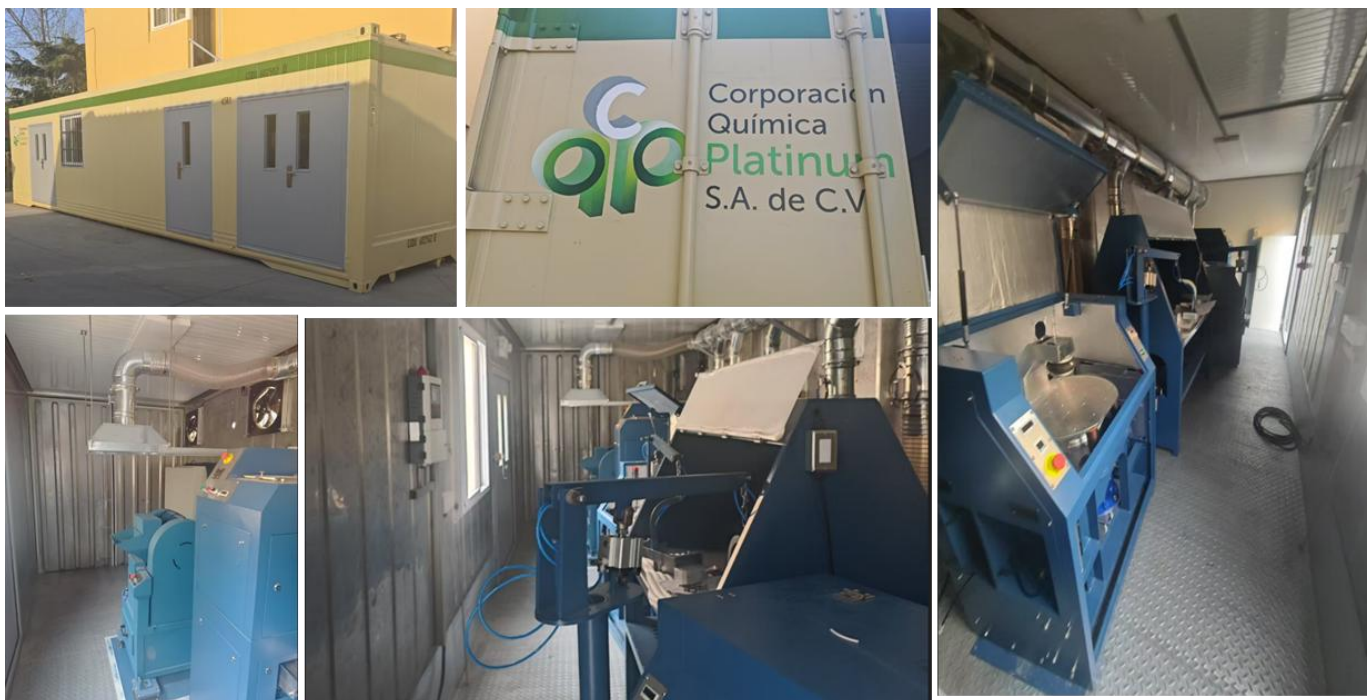
Fig. 1. Laboratorios móviles para preparación mecánica de muestras de CQP.
